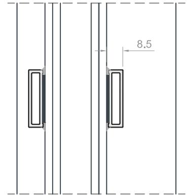
Para una correcta fijación de la cinta 151049 se deben limpiar el perfil y el vidrio con alcohol isopropílico
